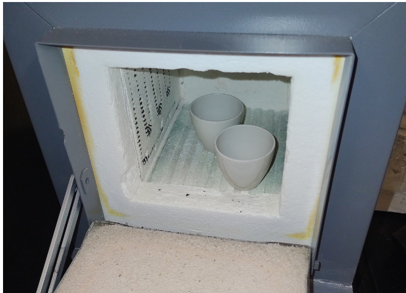
Figura 24. Amostras de solo no forno. A perda por ignição é uma técnica em que amostras de solo são pesadas e, em seguida, aquecidas a altas temperaturas e pesadas novamente. A alta temperatura oxidará qualquer matéria orgânica na amostra, e a diferença de peso será utilizada para calcular a quantidade de matéria orgânica. Fonte da imagem: USGS – NMWSC 2021.
